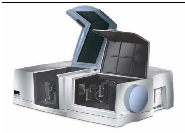
图 2 LAMBDA 950 紫外/可见/近红外系统带 150mm 积分球
