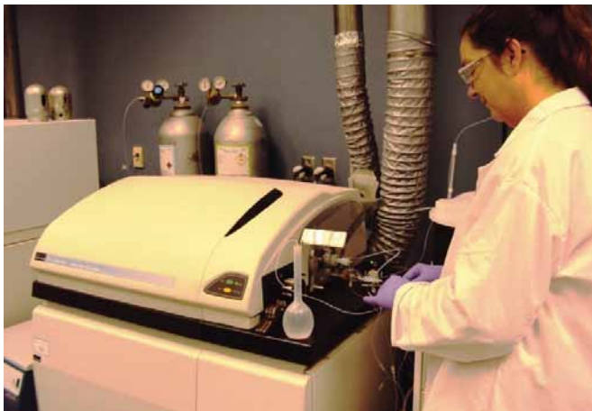
Nutra质量管理/质量控制实验室的PerkinElmer ELAN DRC-e ICP-MS
